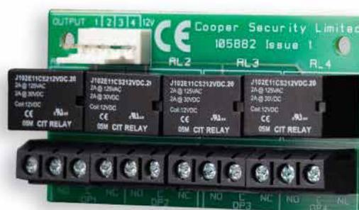
La carte d'extension relais 8600 est conçue pour s'adapter aux récepteurs, centrales et extensions Eaton convertissant les sorties transistorisées en sorties relais à contact sec. Cette carte contient huit relais, chacun avec sa propre entrée dédiée.
